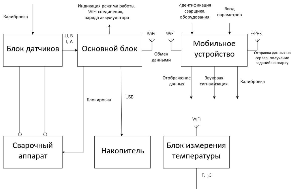
Рис. 1. Структурная схема программно-аппаратного комплекса Fig. 1. Block diagram of the software and hardware complex
