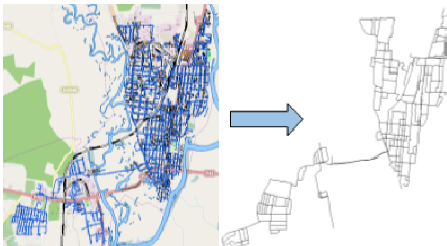
Рисунок 3 – Схема водопровода при математическом моделировании до скелетизации – а и после скелетизации – б
