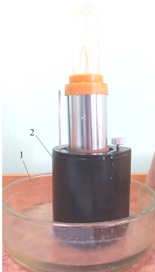
1 – чаша для воды; 2 – прибор для определения коэффициента фильтрации
