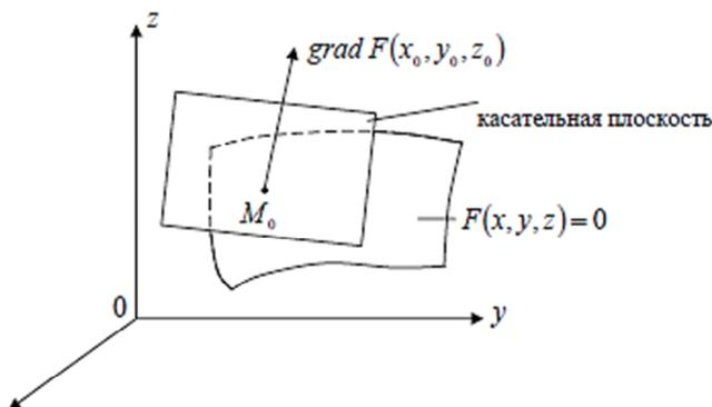
Рис. 4. Касательная плоскость и вектор нормали к поверхности
