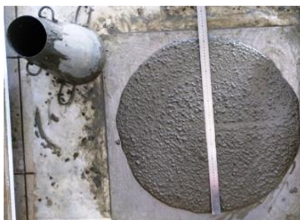
Рис. 3. Определение удобоукладываемости бетонной смеси по расплыву конуса.
