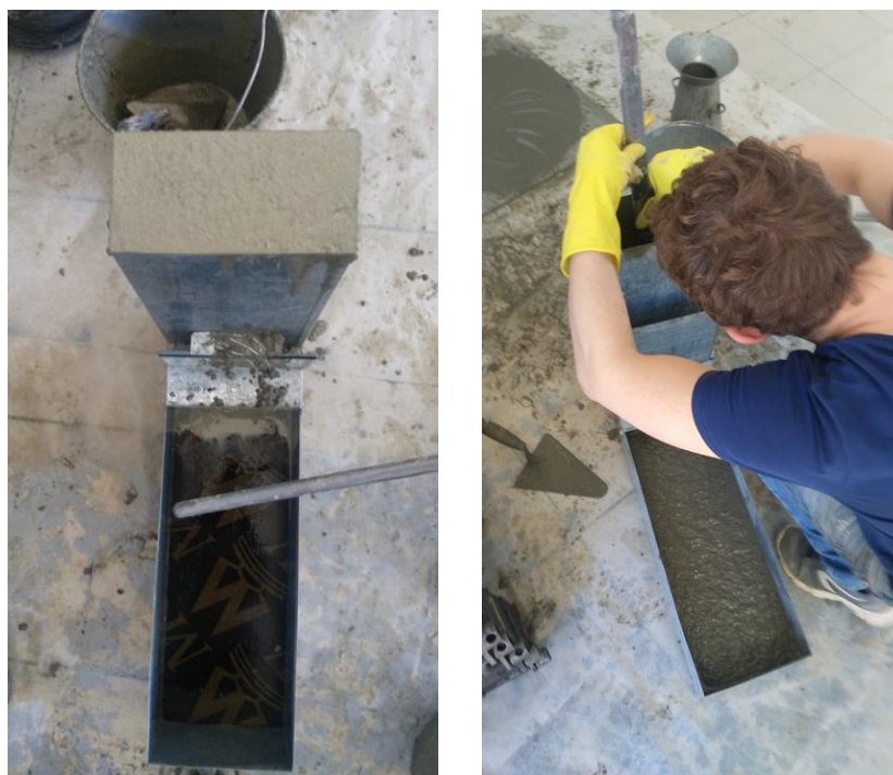
Рис. 4. Определение проходимости бетонной смеси с применением L-образного ящика
