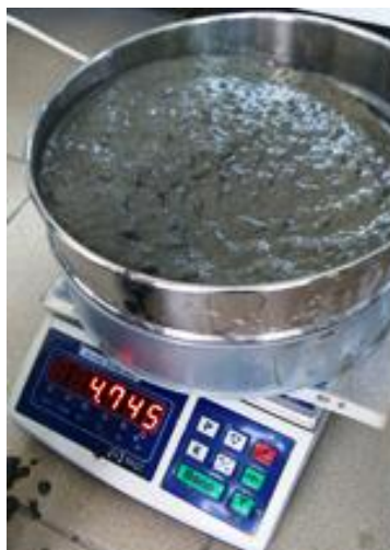
Рис. 5. Определение стойкости бетонной смеси к расслоению методом ситового анализа.
