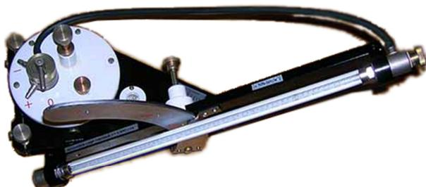
Рис. 1.3. Микроманометр ММН-2400
