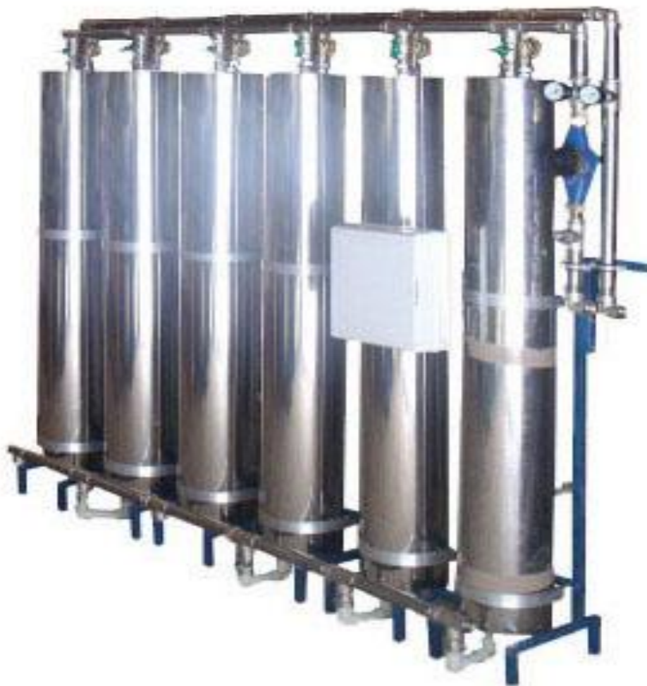
Рисунок 1 – Ультрафильтрационный блок производительностью 15–20 м 3 /ч [3]
