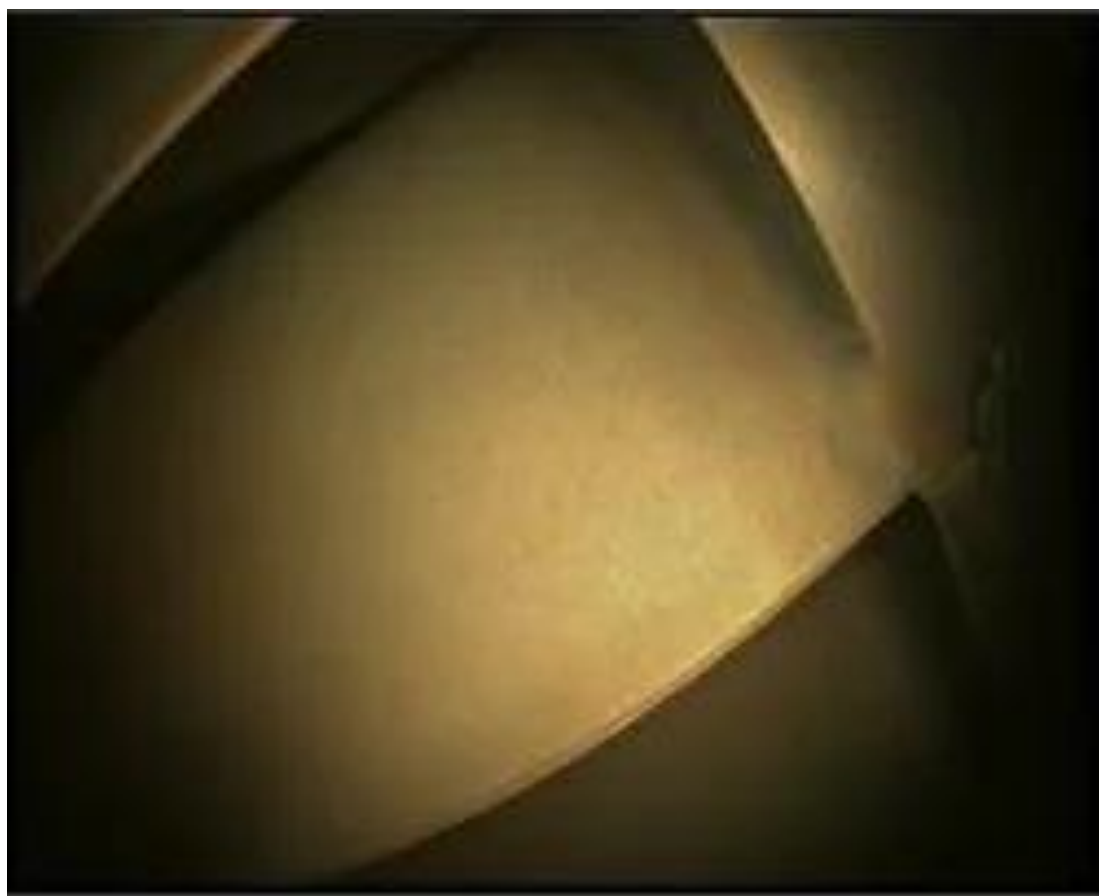
Рисунок 4 – Вид на лопатки первой ступени ГТУ типа GE MS5001 на экране бороскопа [2]
