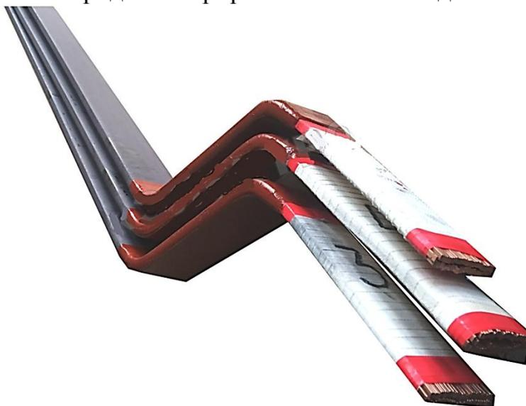
Рисунок 4 – Стержень обмотки статора
