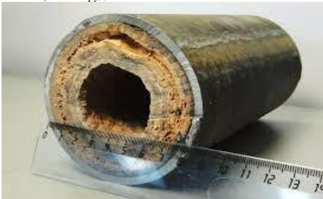
Рисунок 1 – Огромное количество накипи на внутренней поверхности трубы [1]
