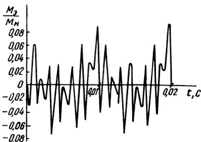
Рис. 4. Электромагнитный момент двигателя.
