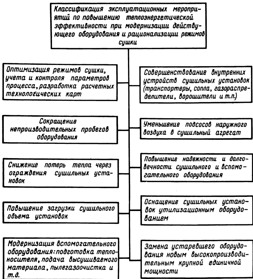
Рис. 2. Методы повышения энергетической эффективности при модернизации действующего сушильного оборудования.
