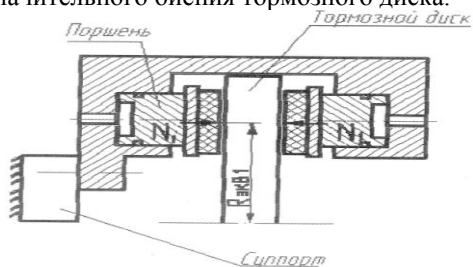
Схема однодискового тормоза сухого трения.
