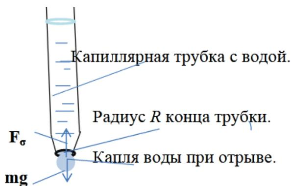
**Рисунок 2** – Капля воды при отрыве
