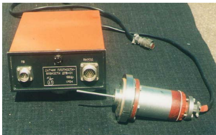
Рисунок 2.3 – Внешний вид вибрационной ИСС измерения вязкости-плотности
