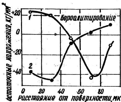
Рис. I. Остаточные напряжения в \alpha - сплаве (кривая 1) и \beta - сплаве (кривая 2)
