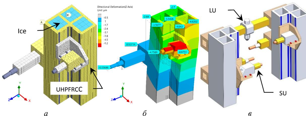
Рисунок 2 – *a* – сетка конечных элементов для L-колонны из фибробетона UHPFRC с заполнителем полостей Ice; *б* – расчетная картина перемещений колонны по Z (мкм) под действием силы в 1 кН (*б*;  $\times 100000$ ); *в* – порталный АСС из двух L-колонн с головками LU и SU
