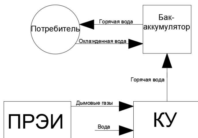
Рисунок 2 – Передача горячей воды на дальнейшее расстояние
