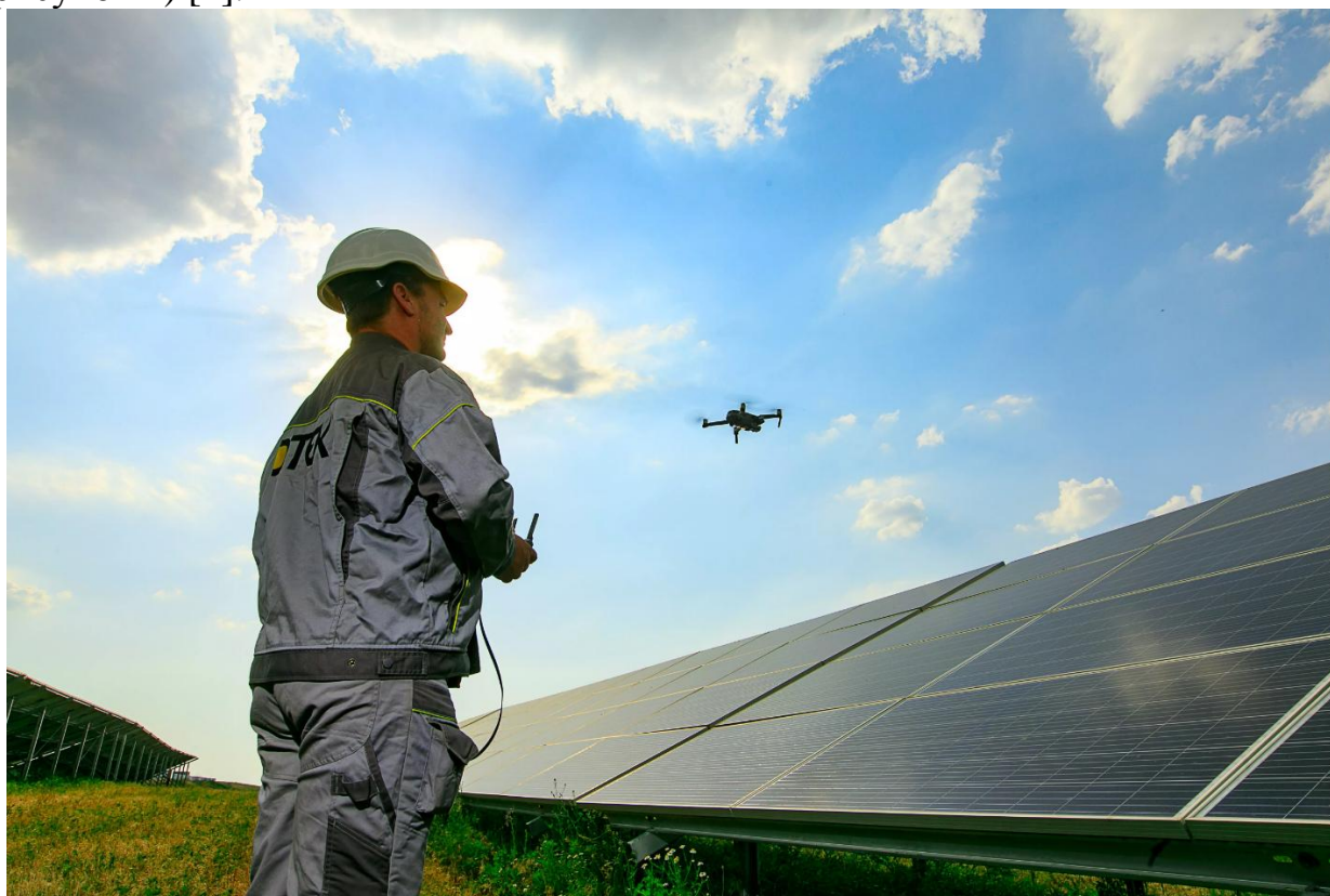
Рисунок 1 – Использование БПЛА для проверки фотоэлектрических панелей [2]
