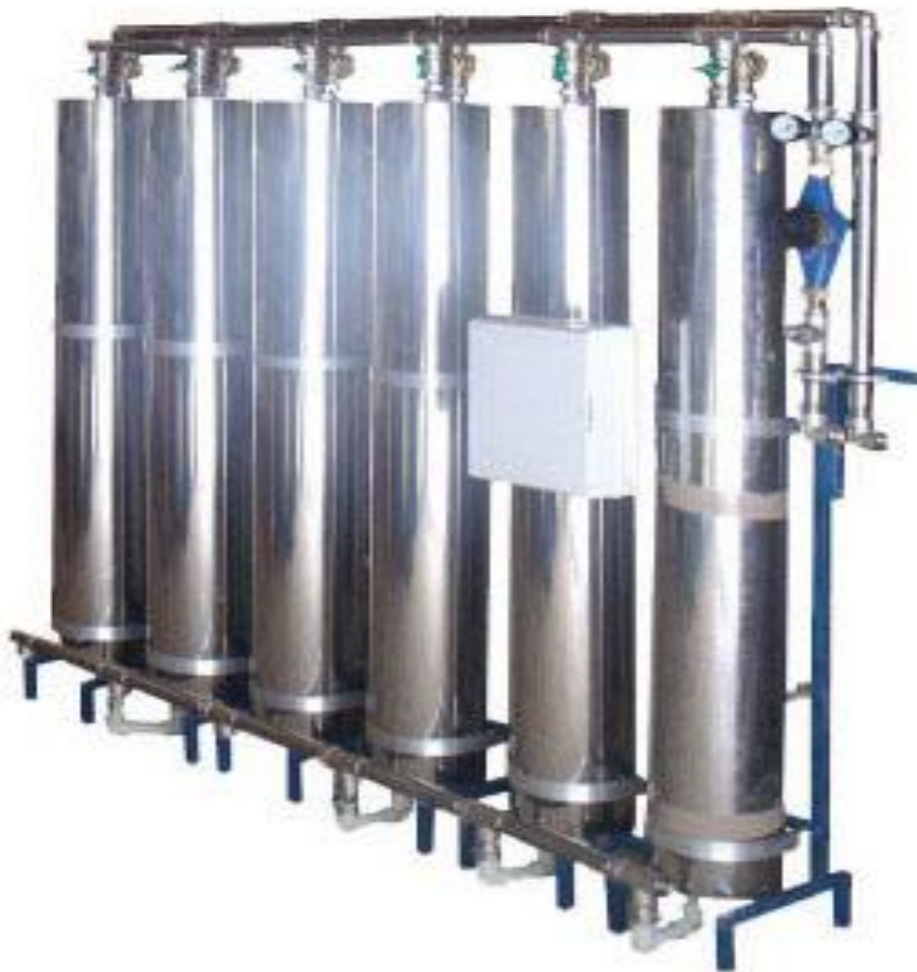
Рисунок 1 – Ультрафильтрационный блок производительностью 15–20 м 3 /ч [3]
