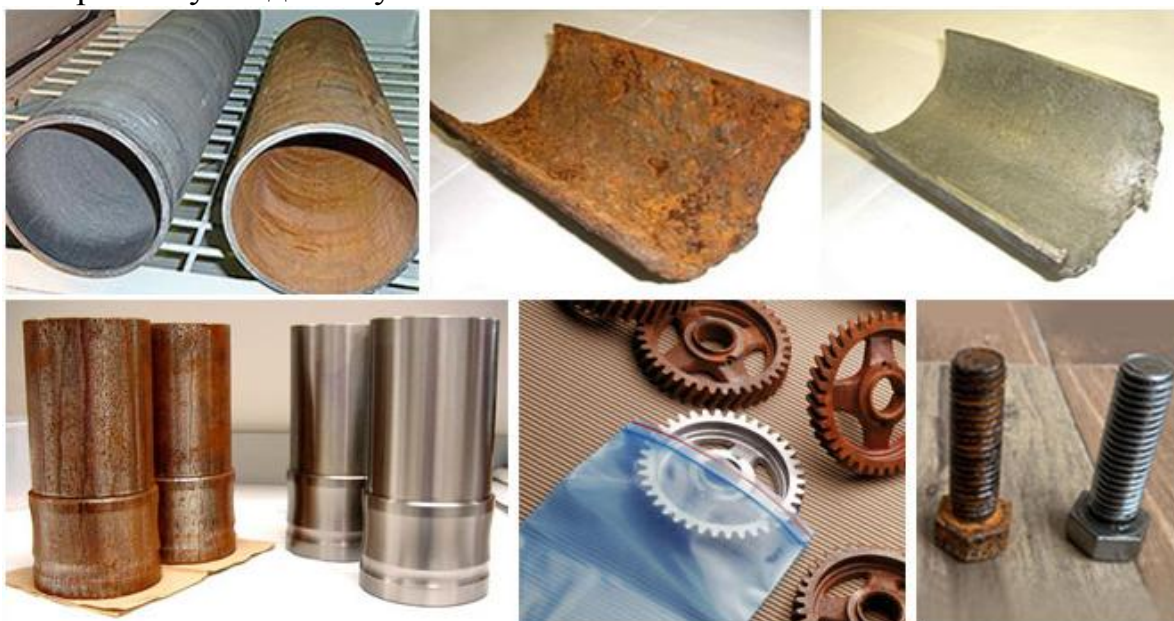
Рисунок 3 – Наглядное действие ингибиторов коррозии [2]
