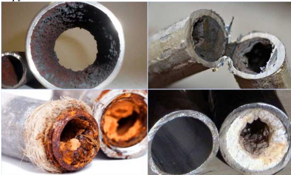
Рисунок 1 – Засорение трубопровода механическими частицами [1]
