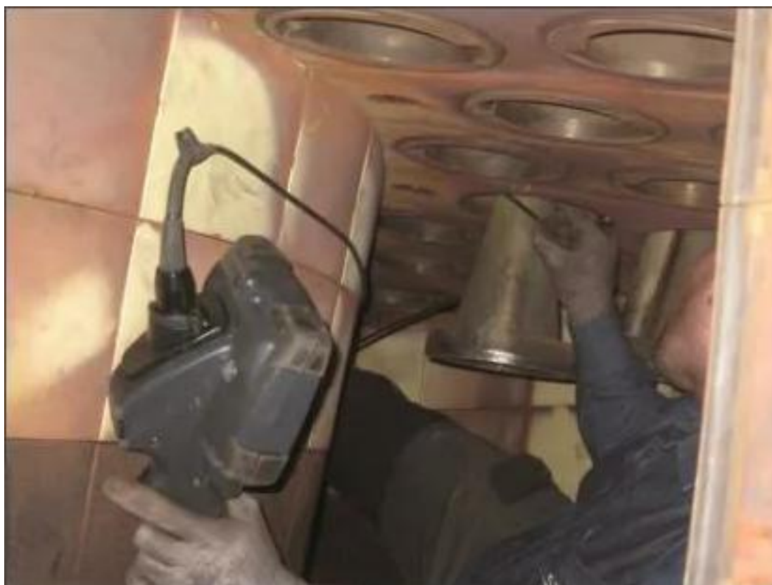
Рисунок 3 – Осмотр бороскопом горелочной камеры ГТУ типа GT13E2 [2]
