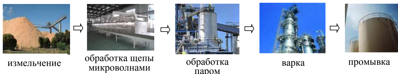
Рисунок 2 – Схема технологического процесса
