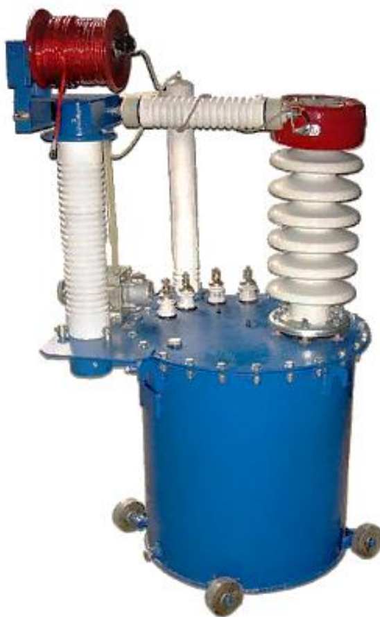
Рисунок 4 – Испытательный трансформатор ИОМ-100/25
