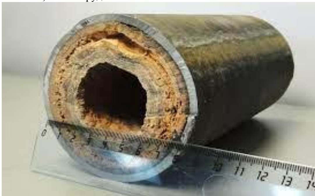
Рисунок 1 – Огромное количество накипи на внутренней поверхности трубы [1]
