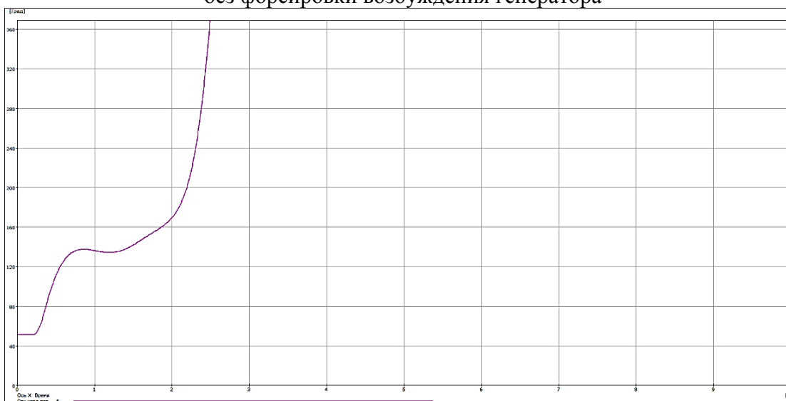
Рисунок 8 – Изменение угла \delta генератора при нарушении устойчивости без форсировки возбуждения генератора
