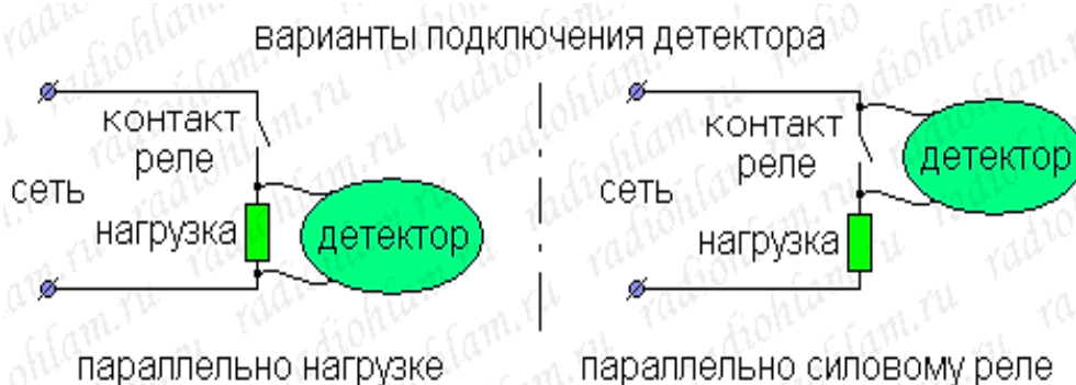
Рисунок 3 – варианты подключения детектора
