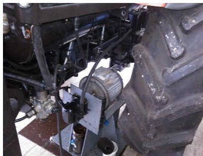
Рисунок 3 – Насосная станция стенда
