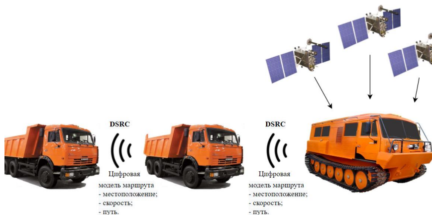
Рисунок 2 – Схема обмена информацией транспортных средств в колонне.
