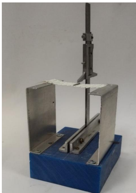
Рисунок 1 – Установка для измерения прогиба
