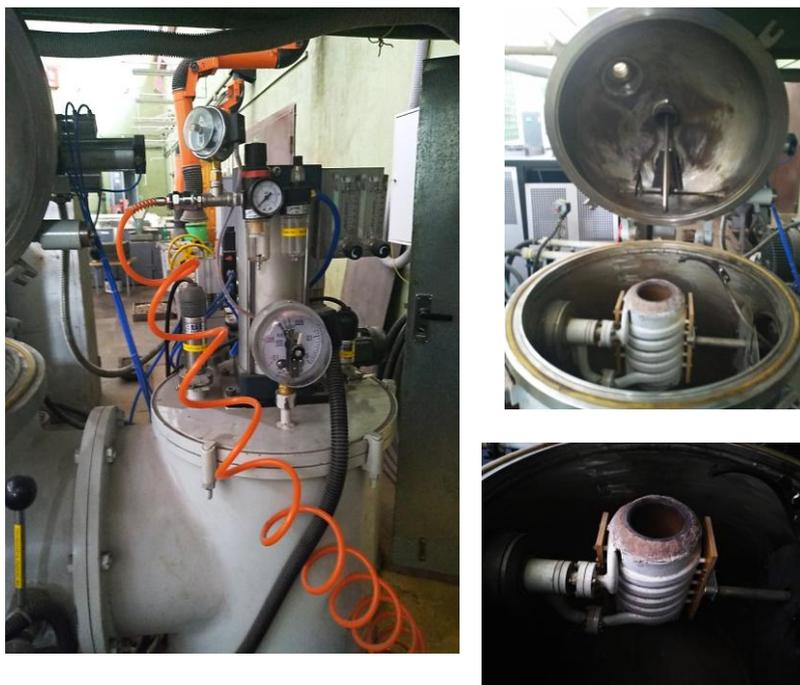
Рисунок 1 – Печь для вакуумно-индукционной плавки
