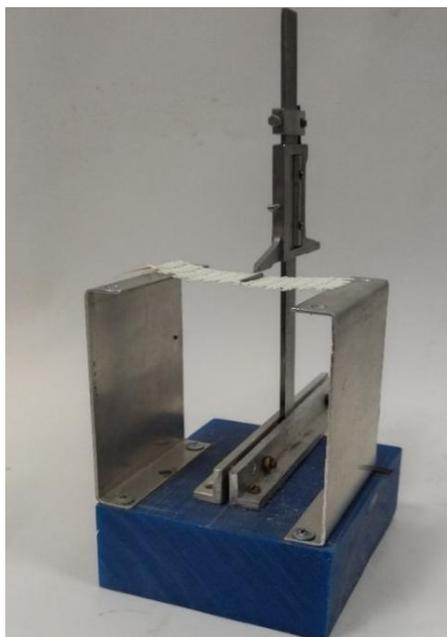
Рисунок 1 – Установка для измерения прогиба
