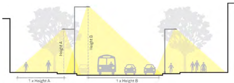
Рис. 4.16. Освещение тротуаров и проезжей части
