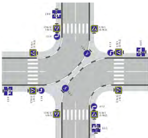
Рис. 6.22. Обустройство перекрестка дивертором по требованиям ГОСТ Р «Дороги автомобильные и улицы. Безопасность движения пешеходов. Общие требования»
