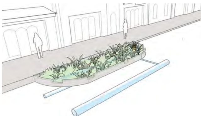
Рис. 10.10. Вариант организации стока в ливневую канализацию
