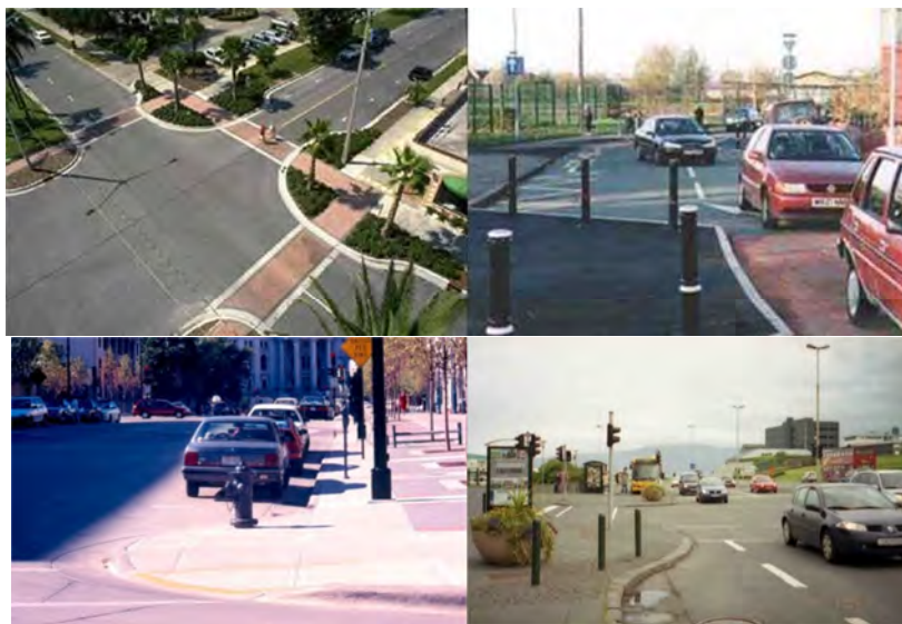
Рис. 6.42. Примеры реализации сужения проезжей части
