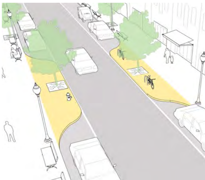
Рис. 9.46. Заужения на участке улицы
