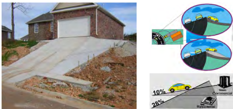
Рис. 5.23. Пример объяснения владельцам земельных участков, домов, гаражей требований к продольному профилю примыканий к проезжей части
