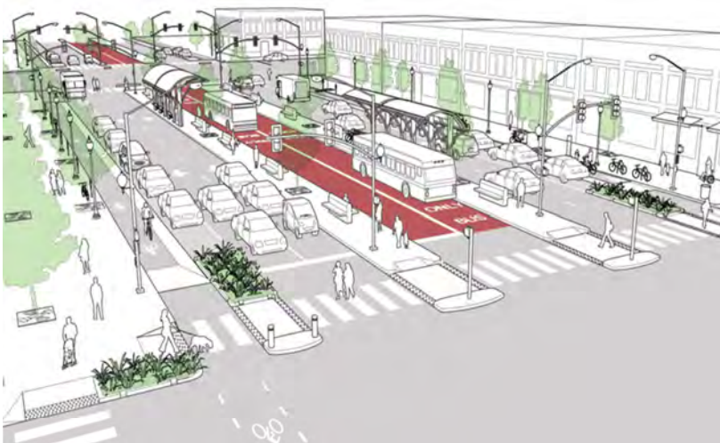
Рис. 12.48. Трансформация улицы с широкой разделительной полосой
