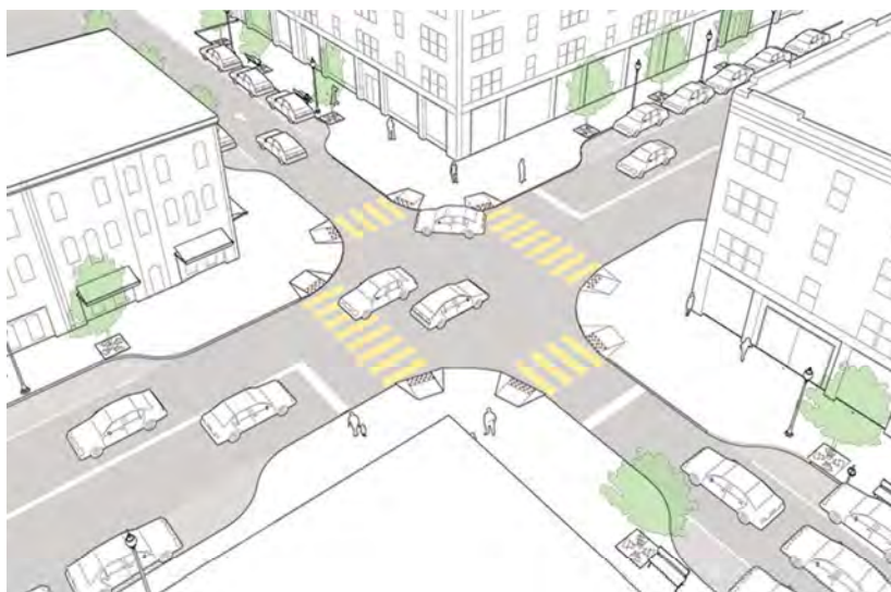
Рис. 9.51. Стандартный перекресток с заужениями в зоне пешеходных переходов
