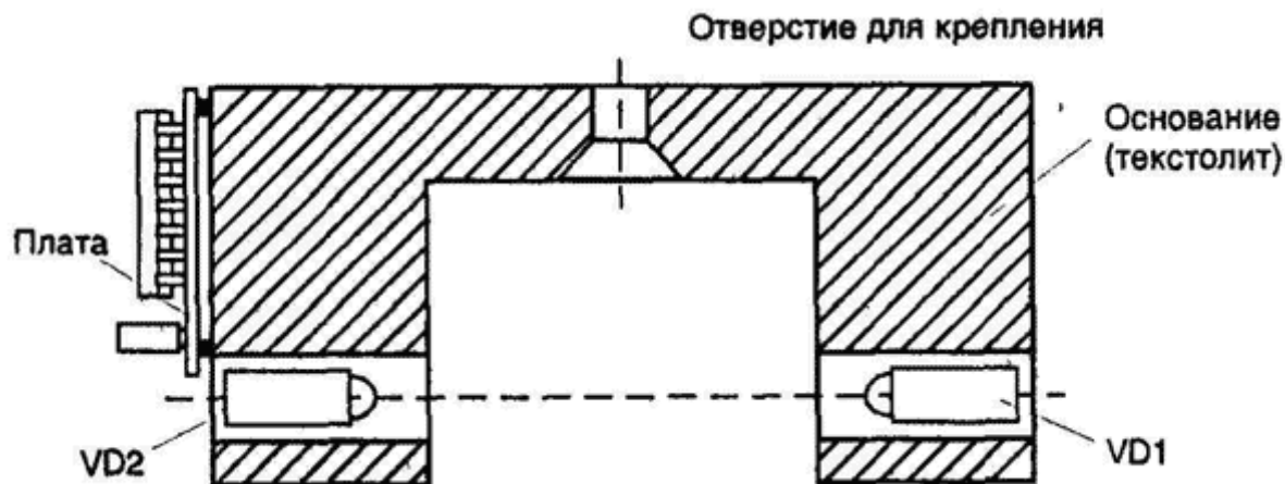
Рисунок 5. Принципиальная схема датчика дыма
