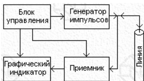
Рисунок 1 – Упрощенная структурная схема импульсного рефлектометра
