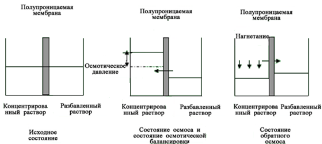
Рисунок 1 – Схема осмоса и обратного осмоса [3]
