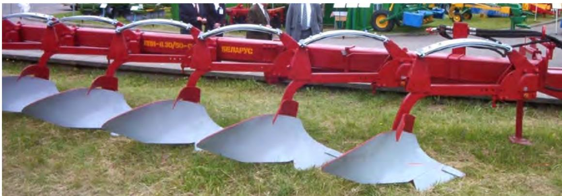
Рис. 1. Многокорпусный плуг с рессорной защитой
