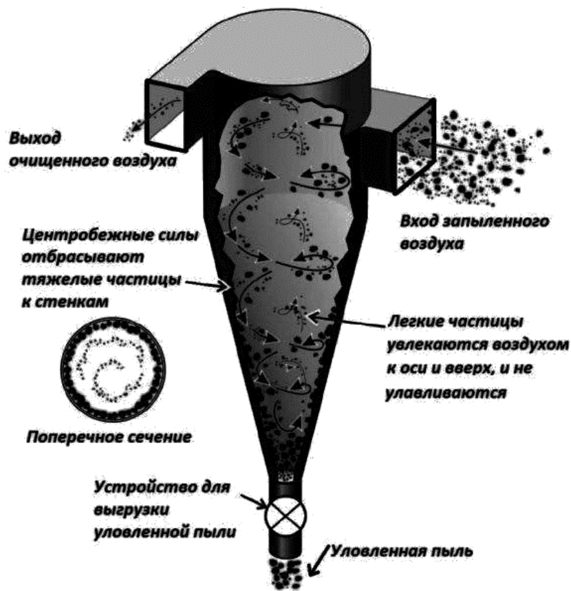
Рисунок 2 – Циклонный разделитель [2]
