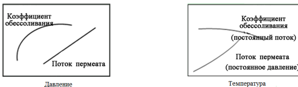
Рисунок 4 – Влияние давления и температуры впускной воды на поток и коэффициент обессоливания [источник: собственная разработка автора]
