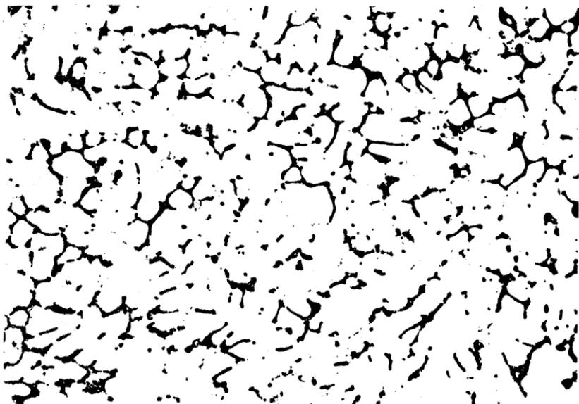
Рис. 4,б. Микроструктура сплава, обработанного ультразвуком
