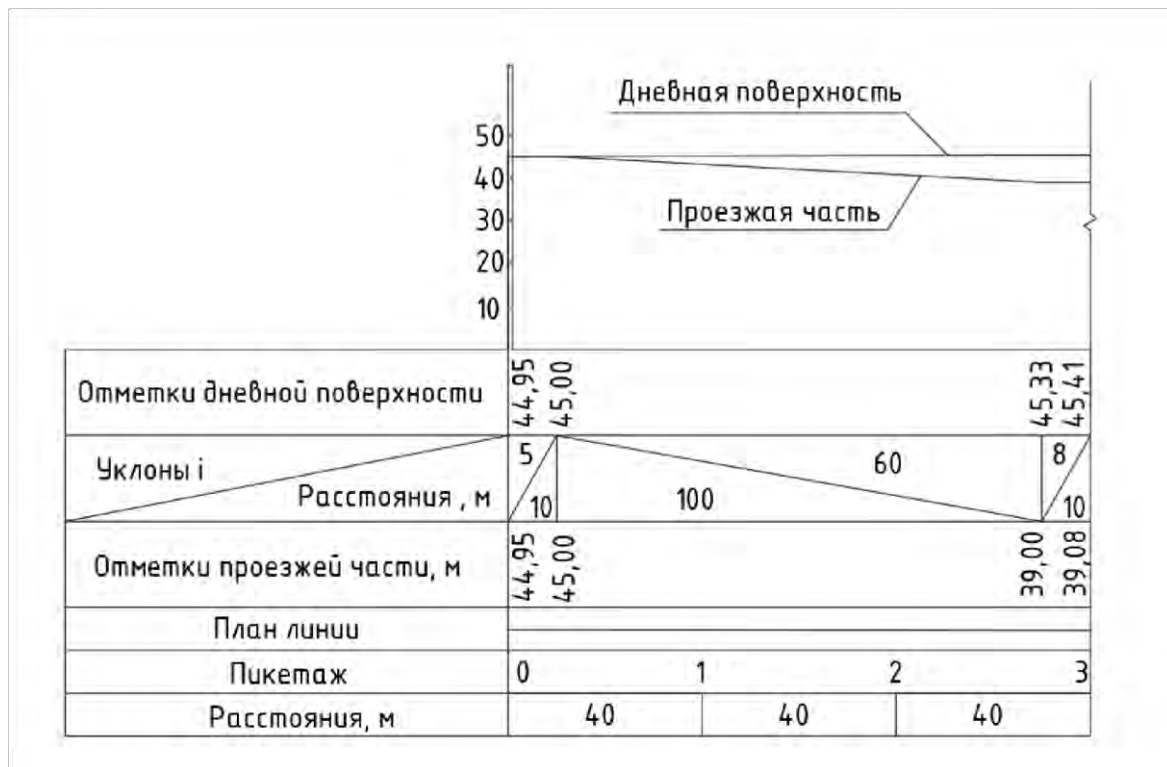
Рисунок 4 – Продольный профиль трассы тоннеля в точке А.
