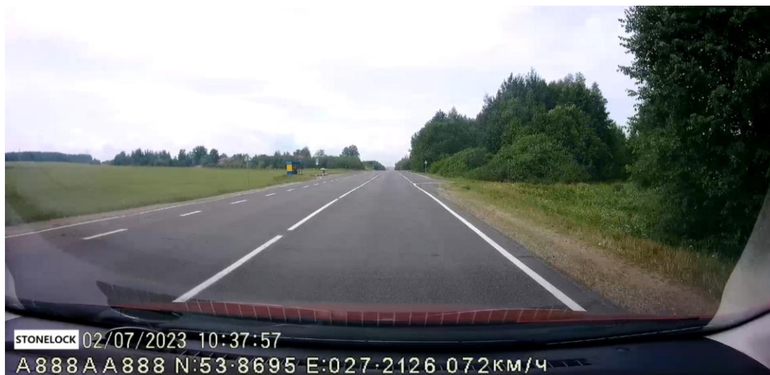
Рисунок 5 – Примыкание справа, видимость 60 м, распознаваемость 40 м
