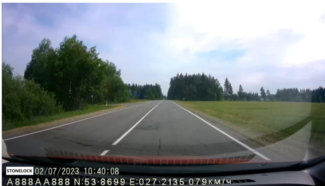
Рисунок 5 – Примыкание слева, видимость 110 м, распознаваемость 66 м
