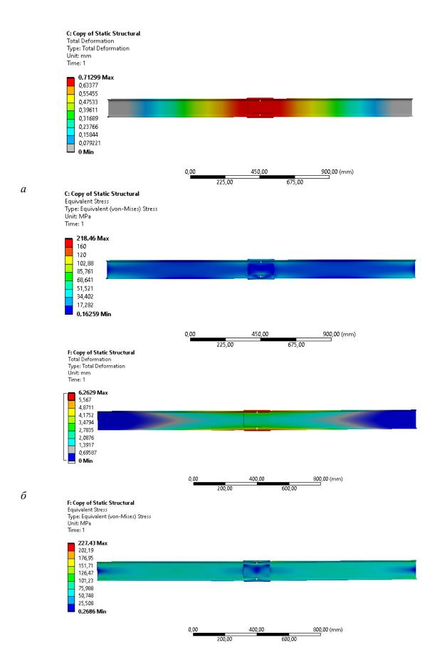
Рис. 4. Результаты статического расчета двутаврового и таврового соединений: a — схема деформирования сварного двутаврового соединения;  $\delta$  — схема напряжения сварного таврового соединения
