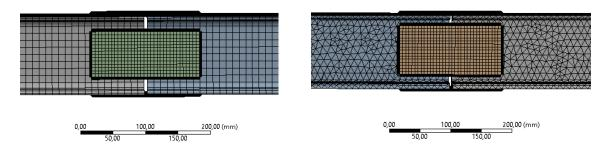
Рис. 2. Вид конечно-элементной модели сварного соединения двутавровой и тавровой балки
