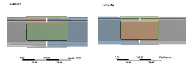
Рис. 1. Модель сварного соединения двутаврового и таврового соединений балок
