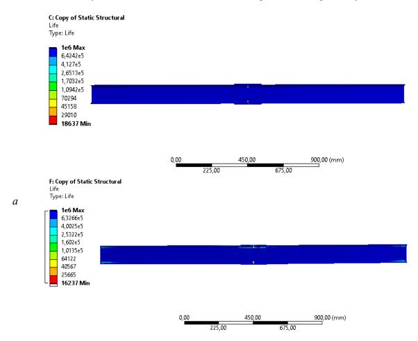
Рис. 5. Результаты циклического расчета двутаврового и таврового соединений: a — схема срока службы сварного двутаврового и таврового соединений,  $\delta$  — схема усталостного повреждения сварного двутаврового и таврового соединений,  $\epsilon$  — схема коэффициент запаса прочности сварного двутаврового и таврового соединений
