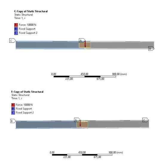
Рис. 3. Физическая модель расчета сварного двутаврового и таврового соединений, нагрузка приложена вдоль соединительной накладки
