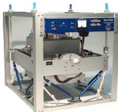
Рисунок 3 – Гиросtabilизированный гравиметр La Coste Romberg
