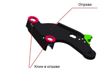
Рисунок 2 – 3D-модель блока клиньев
