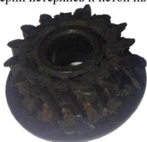
Рисунок 3 – Внешний вид изношенного на 80 процентов зубчатого колеса
