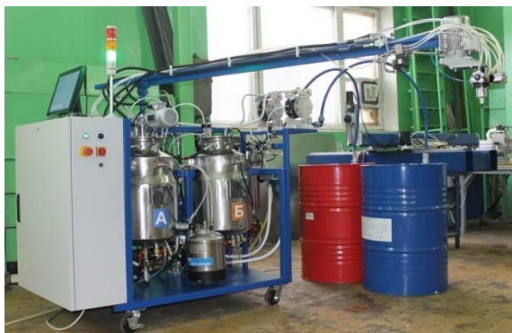
Рисунок 2 – Заливочно-смесительная установка низкого давления для получения теплоизолирующего слоя из пенополиуретановых систем
