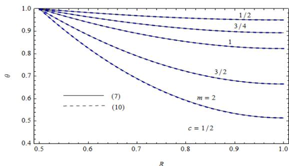
Рисунок 2 – Температурные профили в ребре
