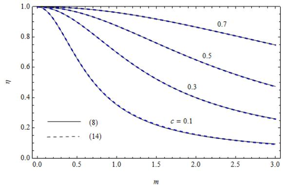
Рисунок 3 – Зависимость теплоотводящей эффективности ребра от параметра  $m$
