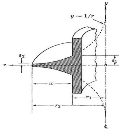
Рисунок 1 – Эскиз кольцевого ребра гиперболического профиля [5]
