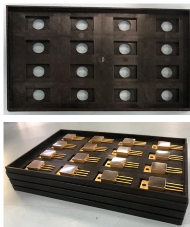
Рисунок 1 – Приборы в корпусе КТ-97В в кассетах из угленаполненного полиамида УПА 6-20
