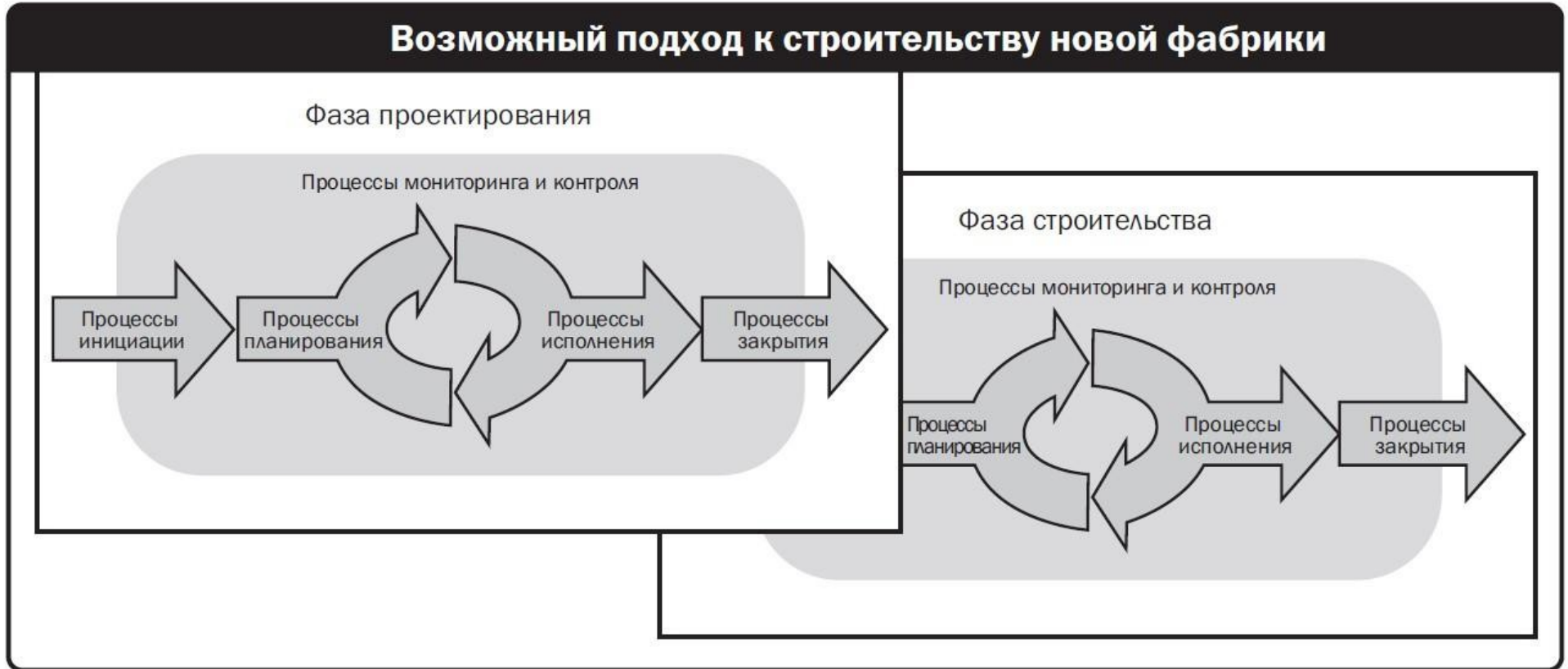
Рис. 2-12. Пример проекта с перекрывающимися фазами
