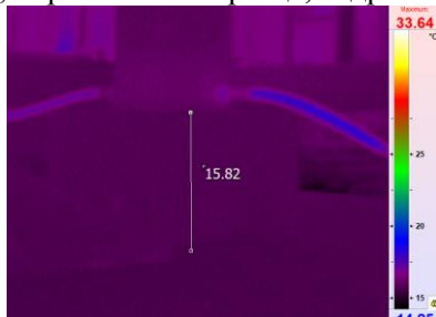
Рисунок 18 – Изменение температурного поля в фиксированных точках поверхности образца при его нагружении в стенде возрастающей нагрузкой от нуля до 100 тонн
