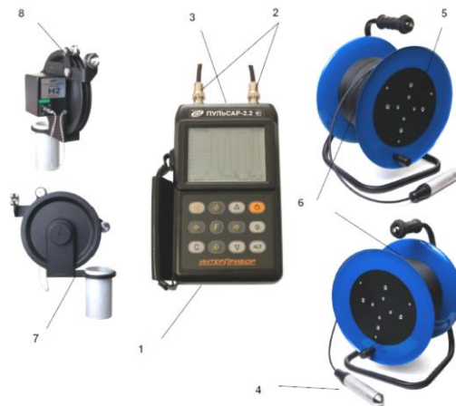
Рисунок 1 – Состав измерительного комплекса Пульсар-2.2 версия ДБС: 1 – электронный блок; 2 – разъемы для подключения ультразвуковых датчиков; 3 – разъем для подключения датчиков длины кабеля; 4 – УЗ датчик; 5 – смотчики кабеля; 6 – кабель для подключения УЗ датчиков; 7, 8 – датчики положения Н1, Н2
