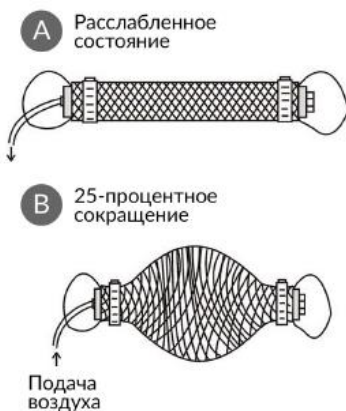
Рисунок 2 – Принцип работы пневмического мускула
