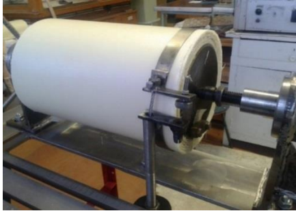
Рисунок 1 – Приспособление для проведения испытаний для определения трансверсального модуля упругости
