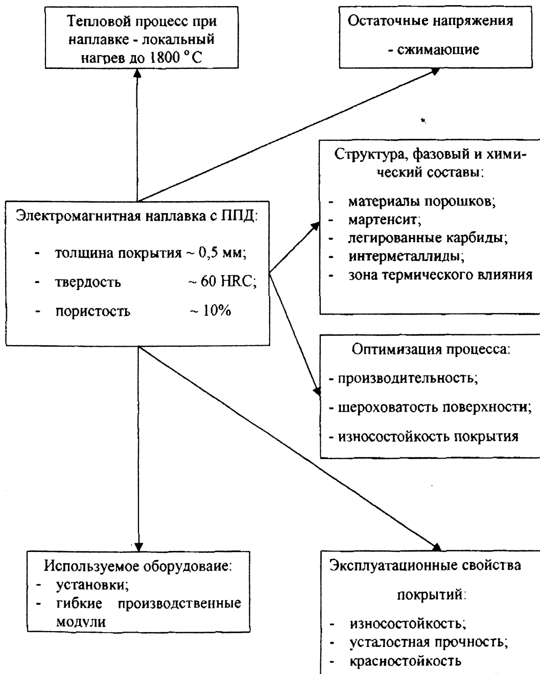
Рис.1. Структура метода электромагнитной наплавки с ППД
