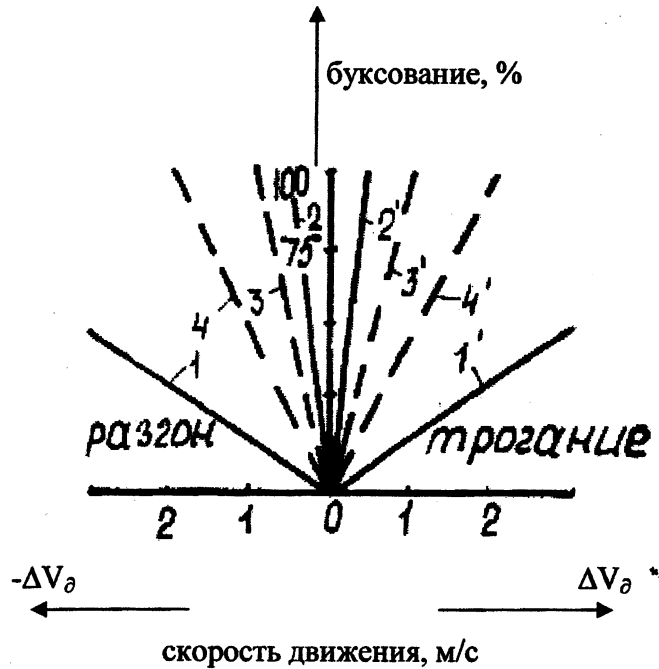
Рис. 2.1. Законы оптимального управления тягово-скоростным режимом при разгоне и трогании с места трактора "Беларус": 1, 1' - законы оптимального управления; 2, 2'; 3, 3' - законы управления трактора с одним (2, 2') и двумя (3, 3') ведущими мостами; 4, 4' - законы управления при блокировании межосевого привода и межколесных дифференциалов.
