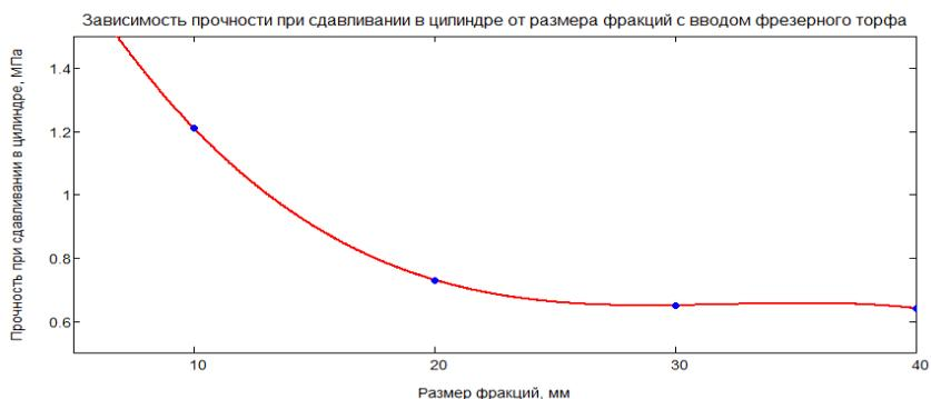
Рис. 3.3. Зависимость прочности аглопорита при сжатии в цилиндре от размера его фракций с вводом фрезерного торфа
