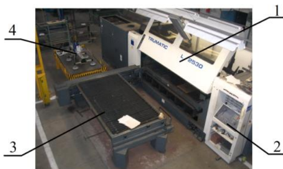
Рисунок 1 – Внешний вид комплекса лазерной резки TRUMATIC L2530
