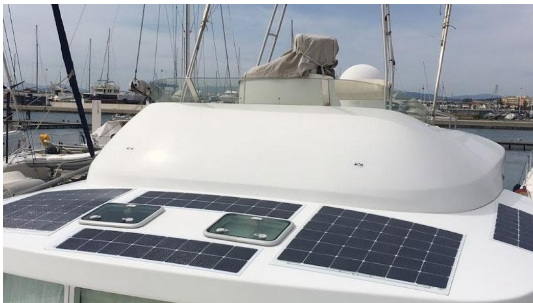
Рисунок 3 – Солнечные панели установлены на крыше катера
