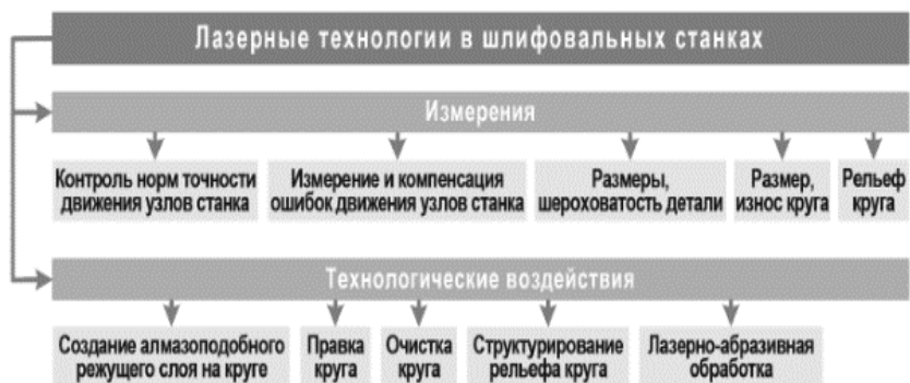
Рисунок 5 – Применение лазерных технологий в шлифовальных станках
